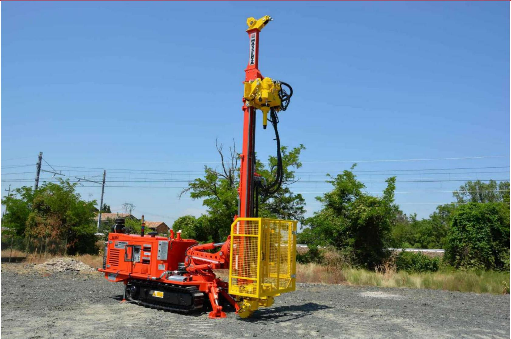
tipurpose; grazie al suo speciale design, può eseguire in qualsiasi posizione micropali, ancoraggi, sondaggi geognostici e anche pozzi d'acqua e perforazioni per
