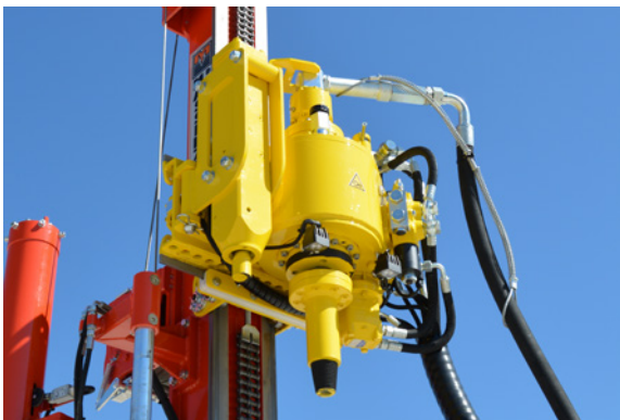
Testa di rotazione con martello a percussione Rotary head with hydraulic hammer Tête de rotation avec marteaux hydraulique Drehkopf bei hydraulii hämmer Cabeza de rotación con Martillo Hidráulico Головка вращения с ударным молотом
