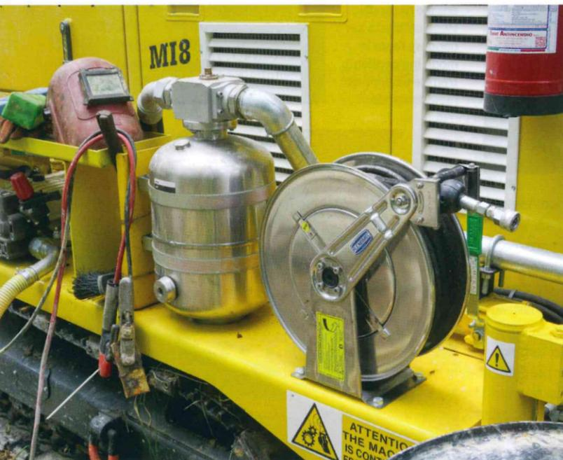
La macchina è equipaggiata con il lubrificatore per la lubrificazione del martello
